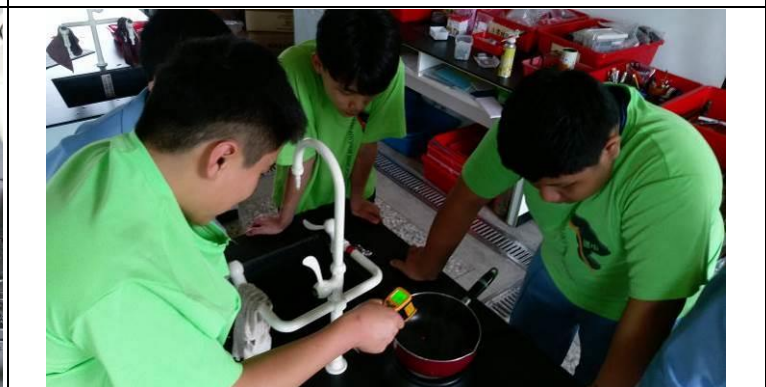
說明：利用紅外線溫度計測量鍋子溫度
